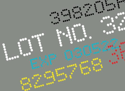
Les encres pigmentées permettent d'imprimer des codes à fort contraste sur un large éventail de couleurs de support. En associant une impression à jet d'encre continu à des encres pigmentées, vous pourrez :
